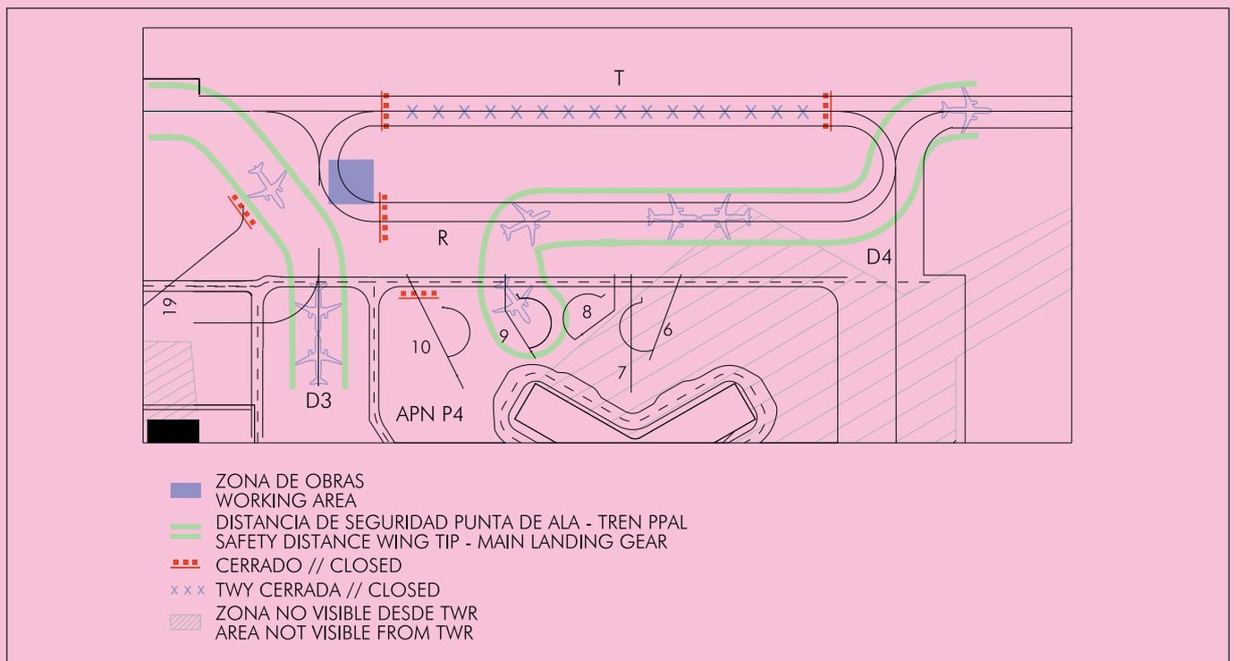
Una vez finalizadas las fases 7A y 7B se elimina la necesidad de realizar sobreviraje en el giro T-D3-R para las aeronaves de letra de clave D y E.
