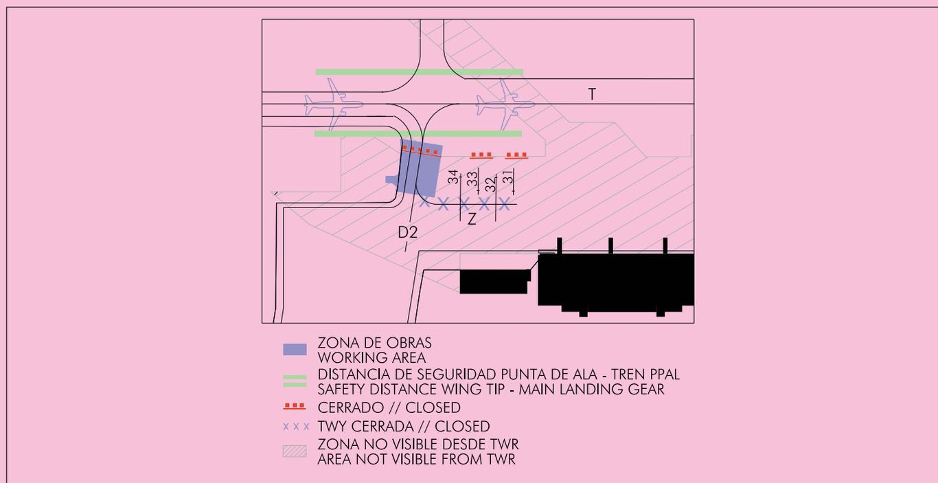
**FASE 11: Retirada de pasarelas obsoletas de plataforma P3 y demolición de sus correspondientes prepasarelas.**
