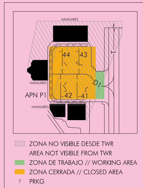
Al finalizar los trabajos, la configuración de la plataforma P1 será la indicada a continuación:
