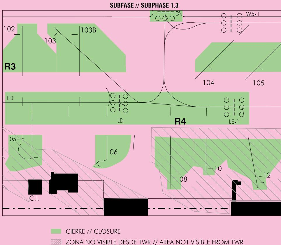
Una vez finalizados los trabajos de la subfase 1.3, la configuración de los estacionamientos quedará como se indica a continuación:
