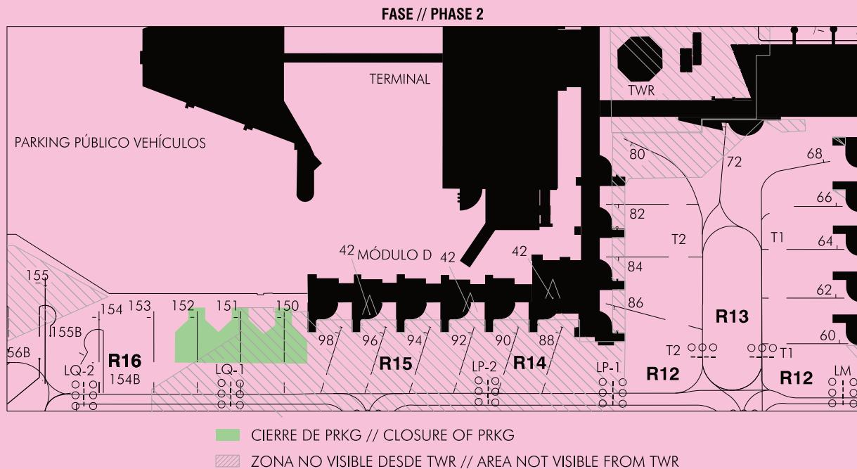
Una vez finalizados los trabajos de la fase 2, la configuración de los estacionamientos quedará como se indica a continuación:
