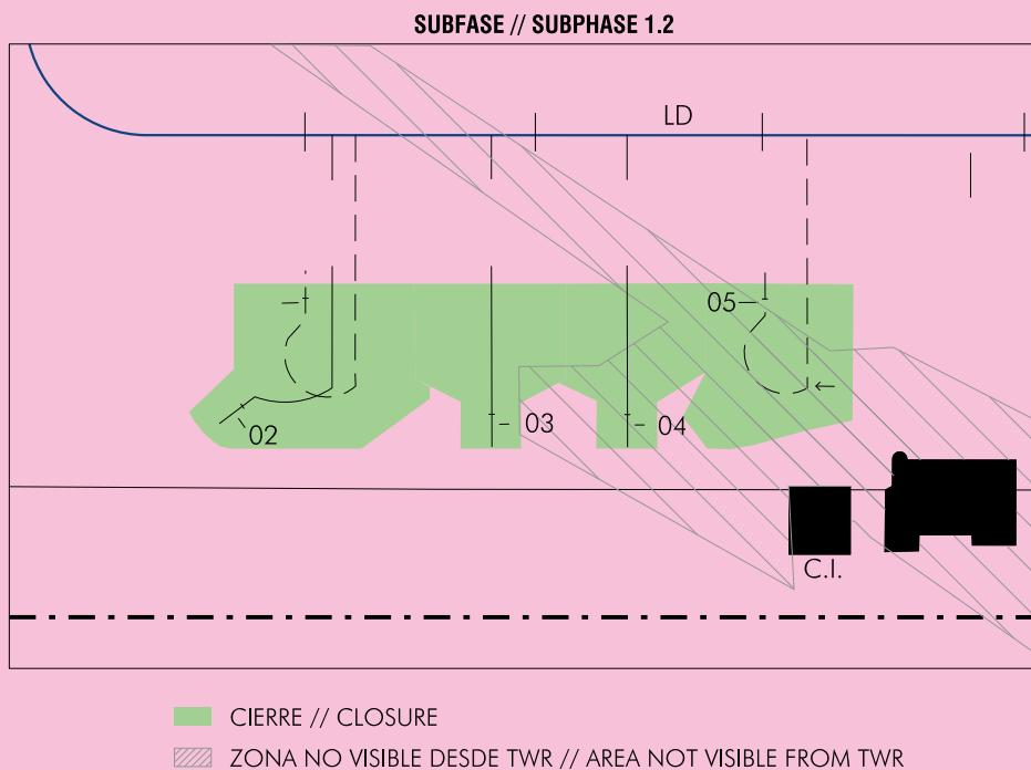
Una vez finalizados los trabajos de la subfase 1.2, la configuración de los estacionamientos quedará como se indica a continuación:
